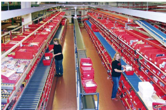
Kommissionierung für den Versandhandel: Mitarbeiter schieben Kommissionierbehälter auf Rollförderbändern an einer Fachbodenregalanlage entlang und befüllen diese mit den angeforderten Positionen.
